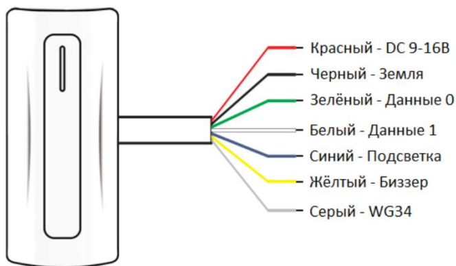
Рисунок 1. Цветовая маркировка проводов
